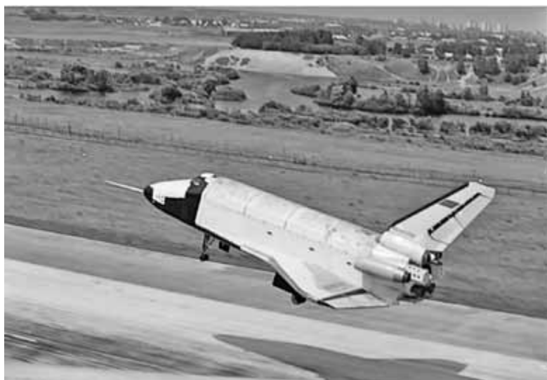
Рис. 2. Автоматическая посадка БТС-002 на аэродроме «Раменское»
